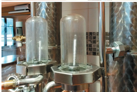
Lihoměry v pálenici, které jsou snímány kamerami DataCam
